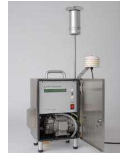
Figure 311 : Préleveur Leckel MVS6
