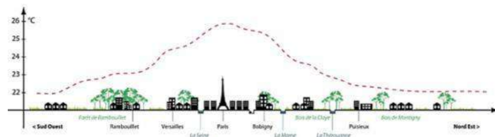
Figure 134 : Coupe schématique de visualisation des températures en 2008 pour une nuit de canicule type été 2003
