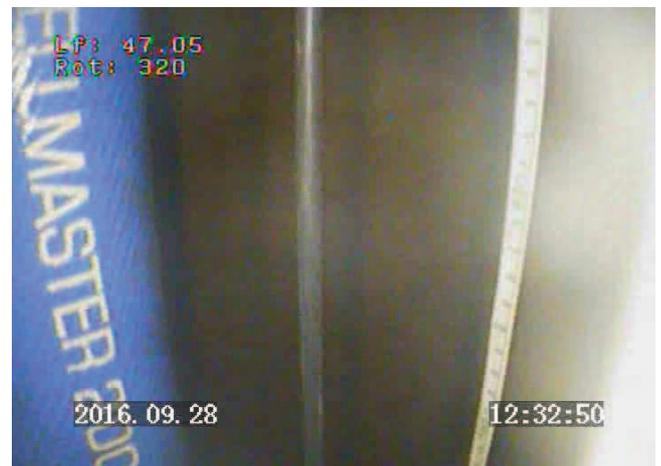
**Pellicule d'oxydes sur les tubages du forage et de la colonne d'exhaure à 50m.**
