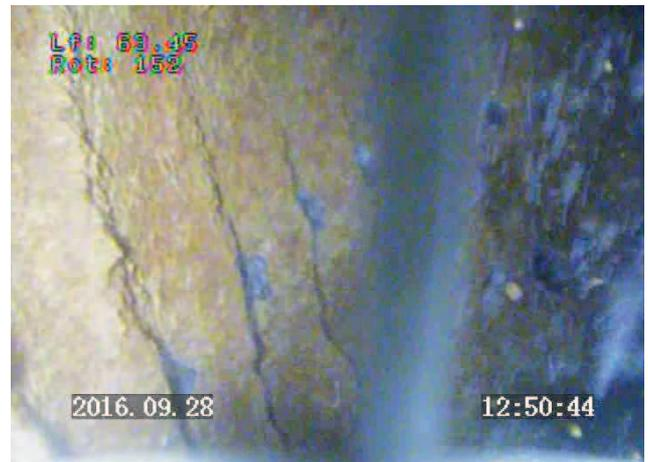
**Filtres partiellement recouverts de dépôts ferrugineux en croûtes et en filaments.**
